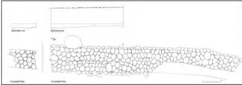
Fig. 15. Vetralla (Vt), Loc. "Mazzacotto". Pianta e sezioni longitudinali dei resti dell'antica Via Cassia.
